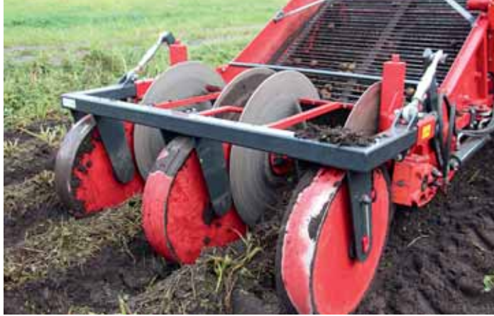
Tolmac équipe ses arracheuses frontales d'un bec d'arrachage sans diabolos avec disques d'arrachage entraînés et de roues de réglage de la profondeur en acier. Un (MT 12) ou deux (MT 14) tapis d'amenée déposent le produit sur un tapis d'évacuation latérale ou centrale.
