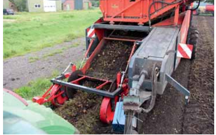
La Dewulf RQA206 de la coopérative Dijkhuis-Hofman arrache avec des disques entraînés au lieu de demi-diabolos. Le timon de l'arracheuse est piloté par GPS à l'aide d'un capteur situé sur le réglage de la profondeur (à gauche sur la photo).
