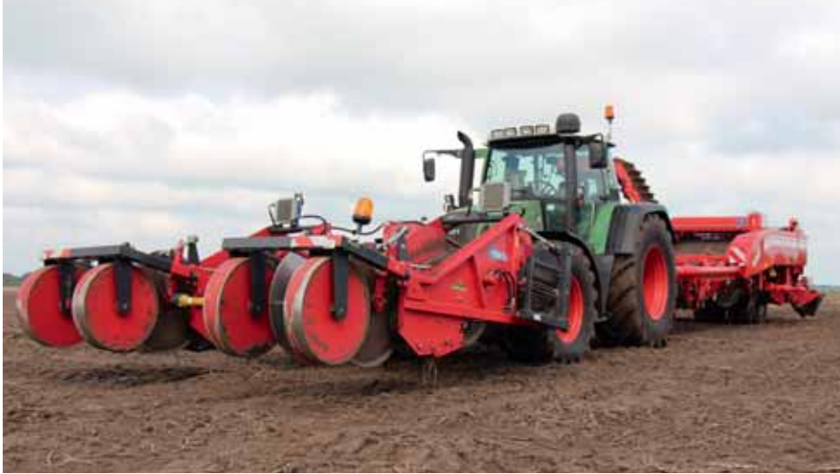
La combinaison d'arrachage se composant d'une MT 14-75 et d'une Grimme GT 170 tractée dans toute sa longueur de Berg Landbouw de Sappemeer. La longueur ne pose pas de problèmes, mais il faut faire attention lors des déplacements sur la voie publique.
